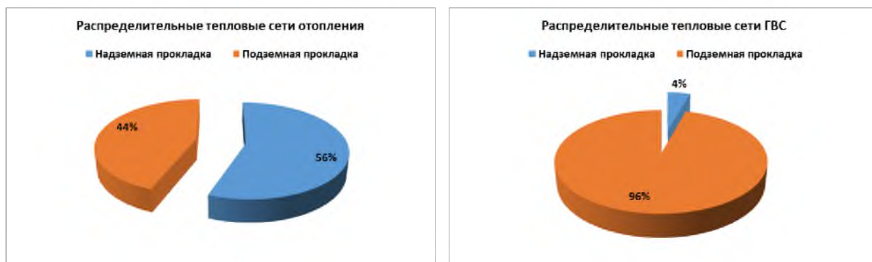
Рисунок 3.17 – Распределение протяженности трубопроводов распределительных тепловых сетей отопления и ГВС по типу прокладки
