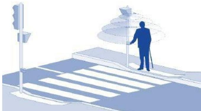
Рисунок 8 – Примеры размещения направленности действия технических средств звуковой сигнализации на регулируемых пешеходных переходах
